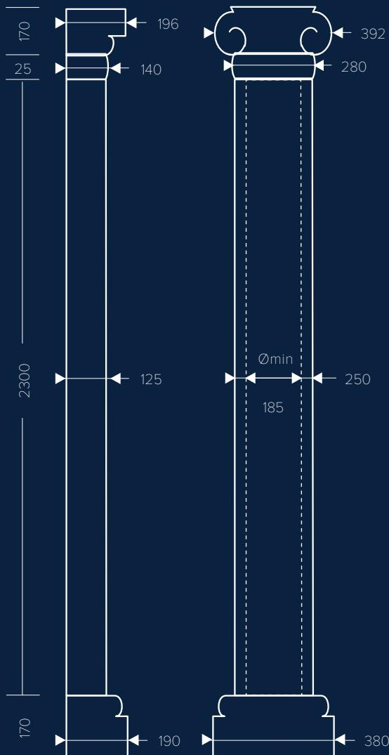
Габаритные размеры конструкции, мм.
