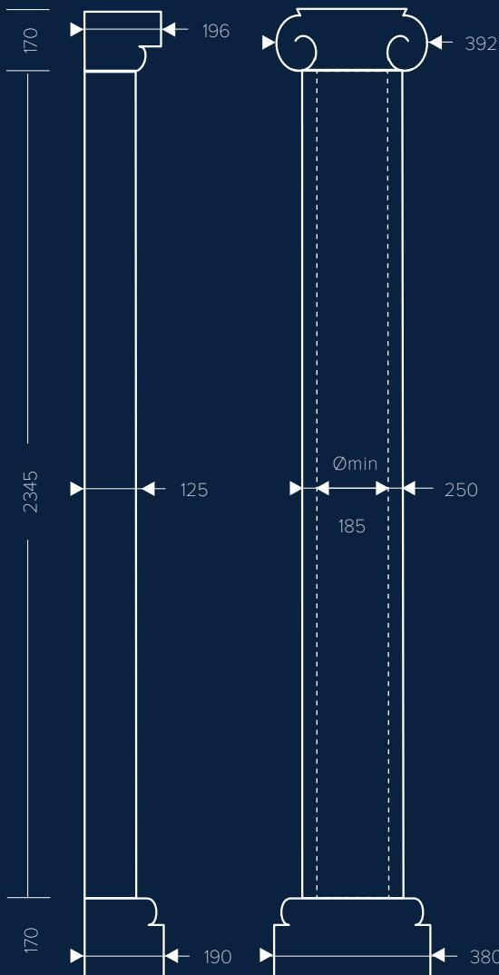
Габаритные размеры конструкции, мм.
